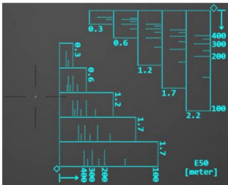
Горизонтальная линия от верхнего правого ромба, является исходной линией вертикальной шкалы измерения. Вертикальные линии оптической пропорции, с длинными пунктирными линиями отметок 100, 200, 300, 400м и короткими 150, 250, 350 и так далее. Длинные строки имеют числовые метки, например, короткая строка между 200 и 300 означает 250.
