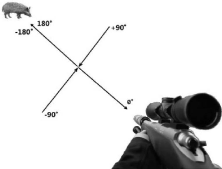
**Скорость ветра** - определение направления ветра показано на Рис. 9. Направление ветра по часовой стрелке от 0 ° до -180 °, скорость ветра <0, против часовой стрелки от 0 ° до 180 °, скорость ветра > 0. Фактическая скорость ветра оценивается по опыту, например, листва, дерево, пыль и другие объекты, движущиеся вместе с ветром.
